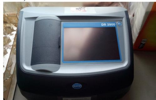
Gambar 3. Alat Spektrofotometri Sinar Tampak (UV-Vis)
